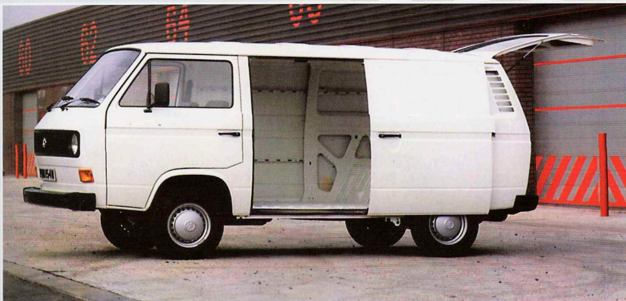
Masivní výklopné dveře v zádi a posuvné dveře postraních umožňovaly pohodlný přístup do výrazně zvětšeného zavazadlového prostoru
