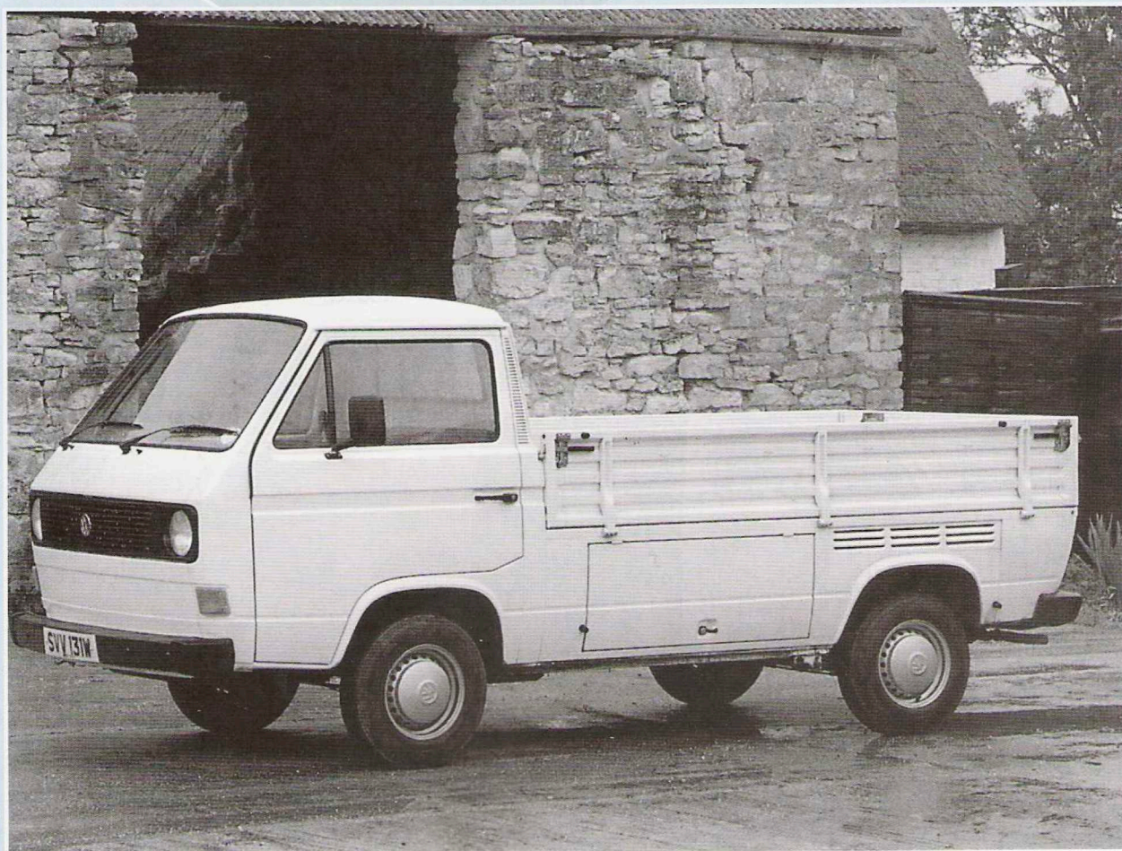
Na sklonku sedmdesátých let čelil Transporter se vzduchem chlazeným motorem v zádi, silící konkurenci, ale dvoumístný pick-up se prodával dobře. Zážehový „dvoulitr“ mu umožňoval dosáhnout rychlosti přes 140 km/h
